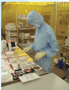
MEMS ジャイロ(上)。 紫外線をカットしたイエロー・ルームでMEMSを製作。画像:日本大学 マイクロ機能デバイスセンター(左)
