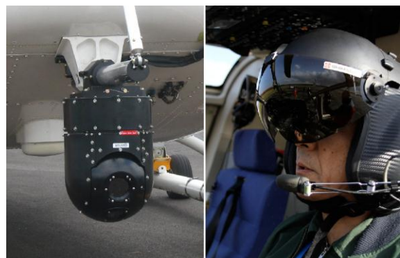
図 7 視覚情報支援システムに用いた機器 (左) 赤外線カメラ、(右) HMD
