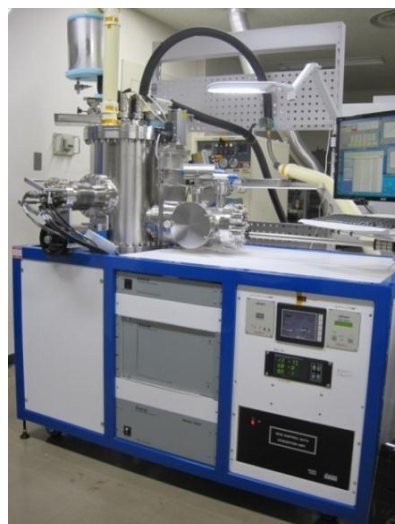
図4 JAXAのアウトガスレート測定装置
