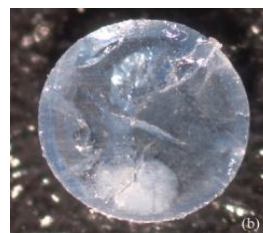
図3 地上静電浮遊炉で作製したチタン酸バリウム ( BaTiO_3 )
