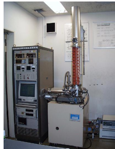
図2 JAXAのアウトガス測定装置
