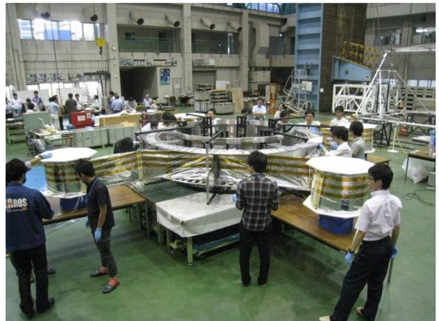
図6 四方のセイルの同時収納実験
