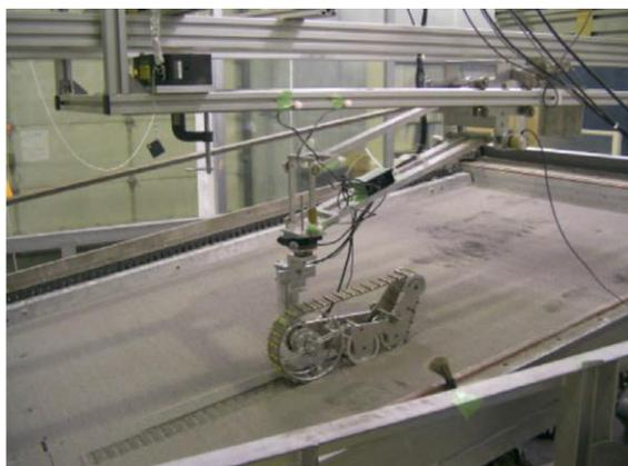
図 3 クローラ機構を用いた斜面登坂実験<sup>[2]</sup>
