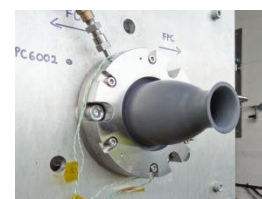
1000N 級月惑星探査用スラスタ (ESA と共同で研究中)
