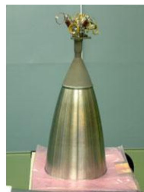
図3 EBM法適用を目指す衛星用スラスタ （写真は IHI エアロスペース社製 500N 級スラスタ）
