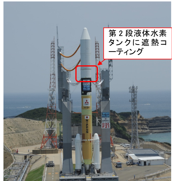
図7 H-IIA ロケット 21号機打上げにおける第2段液体水素タンク遮熱コーティング
