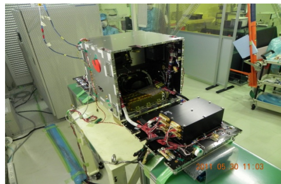
図 3 初期電気性能試験
