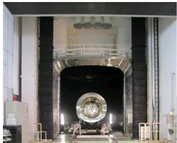
図8 第2段機器搭載部熱真空試験
