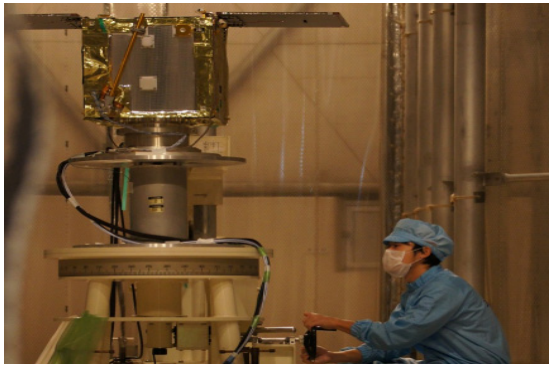
図5 システムPFM磁気試験
