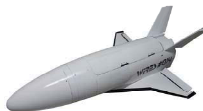
図 9 九州工業大学の実験機 (全長 1.5m、全備質量 50kg)
