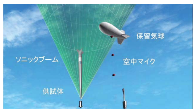
図9 落下中の供試体と係留気球
