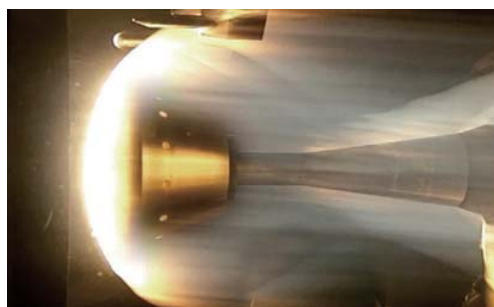
図8 HTV-R 回収機模型による空力加熱試験状況
