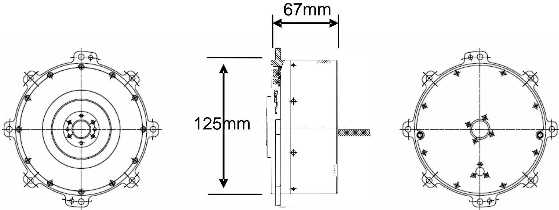
(注記) 125mmは、取付フランジを含まないケースの外径寸法を示している。
