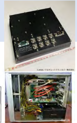
搭載用画像化装置FLIPと画像化ハードウェア構成 出展：JAXA研究開発部門HP
