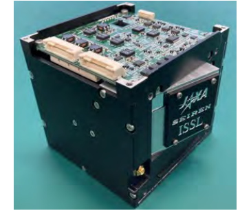
東京大学、セーレン、JAXA:CubeSat向け高精度姿勢制御ユニット、出展:超小型衛星シンポジウム資料
