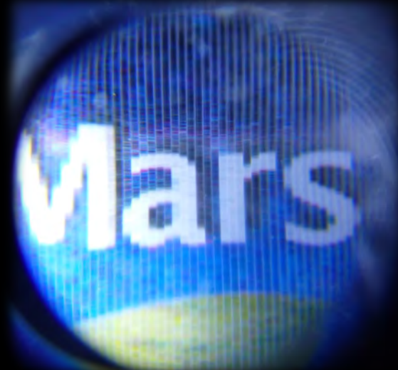
円筒形のレンズとパターン面の組み合わせ『レンチキュラーレンズ』の原理
