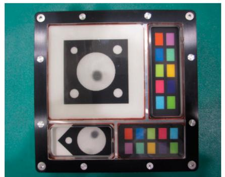
軌道上実験用サンプル。マーカが2つあるのは、カバーの有無で宇宙空間に暴露したときの影響を比較するため。カラーパレットは、将来的にマーカをカラー化して色のパターンで個々のマーカを区別する際に、識別しやすい色の組み合わせを検証するため。
